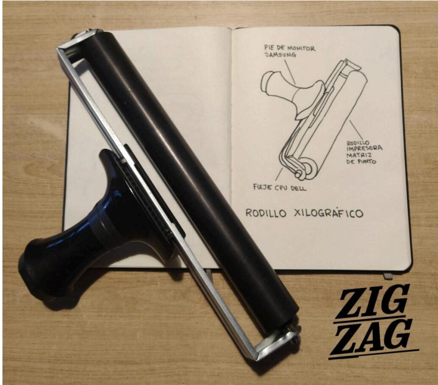
Rodillo para xilografía construido con fragmentos de CPU, monitor e impresora matriz de punto
