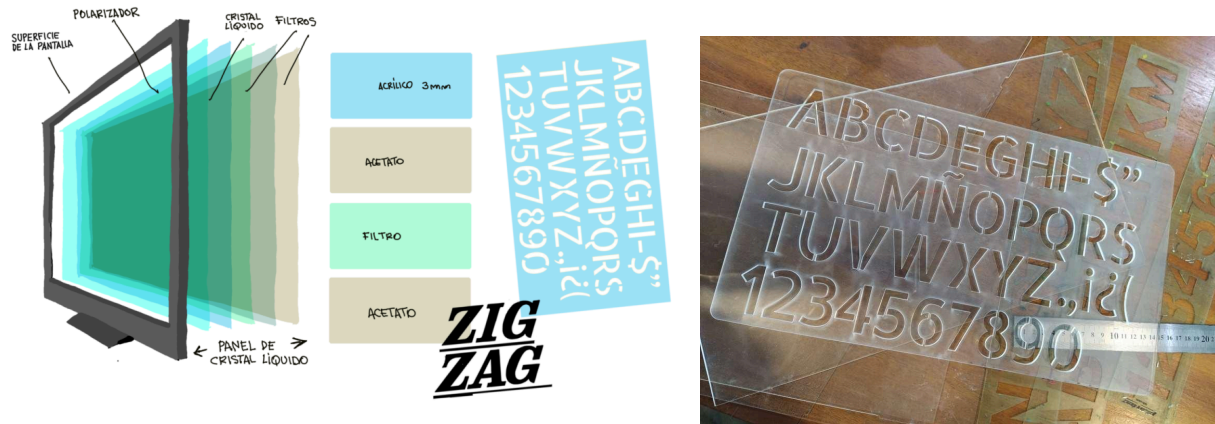
Letrografo construido con material acrílico extraído del interior de monitores
